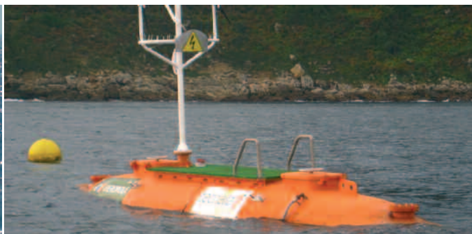
→ Prototipo a escala un cuarto que está desarrollando la empresa OCEANTEC.
